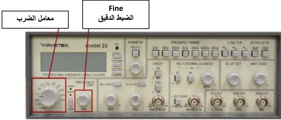
شكل رقم ٤٥: مفاتيح ضبط القيمة المطلوبة للتردد
