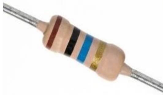
شكل رقم ٥٨: المقاومات الرباعية النطاقات اللونية
